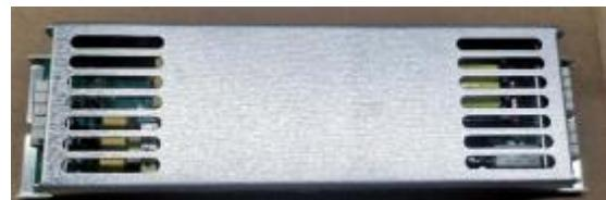
电子镇流器的压接式连接端子能使用的导线截面积为 0.75-1.5mm<sup>2</sup>，按图所示连接到电源和灯管，如果输入和输出端子发生了错误的连接会毁坏电子镇流器。
